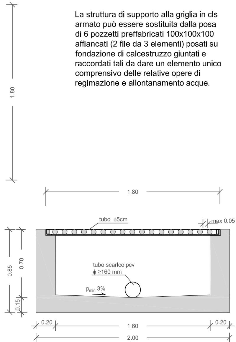
La struttura di supporto alla griglia in cls armato può essere sostituita dalla posa di 6 pozzetti preffabricati 100x100x100 affiancati (2 file da 3 elementi) posati su fondazione di calcestruzzo giuntati e raccordati tali da dare un elemento unico comprensivo delle relative opere di regimazione e allontanamento acque.
